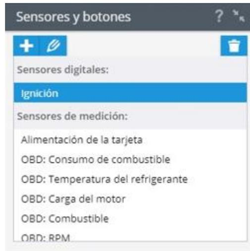
La opción de conectar diferentes sensores varía según el modelo del dispositivo; por ejemplo, para dispositivos OBD2 existe la posibilidad de configurar los datos que se transmiten a través del conector OBD2 de diagnóstico (como se muestra arriba).
