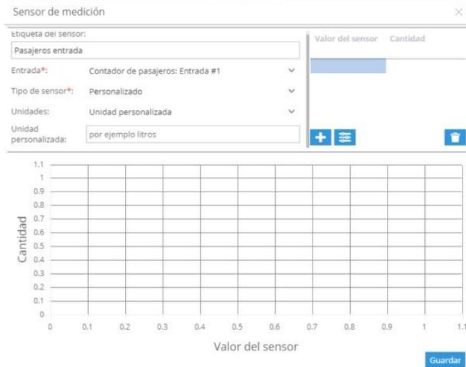
*El dispositivo debe estar equipado con dos sensores: uno para los pasajeros entrantes y el otro para los salientes. Entonces, se necesitan crear dos sensores separados en la configuración del dispositivo.*
